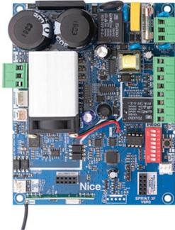
A Sprint 3F é a central inversora para motores trifásicos que traz maior velocidade e confiabilidade para os automatizadores Nice. Utilizada para controlar motores de até 1 CV.
