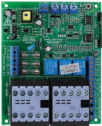
A **CP 4030** é a central para motores monofásicos e trifásicos de tensões de 220/380 V.
