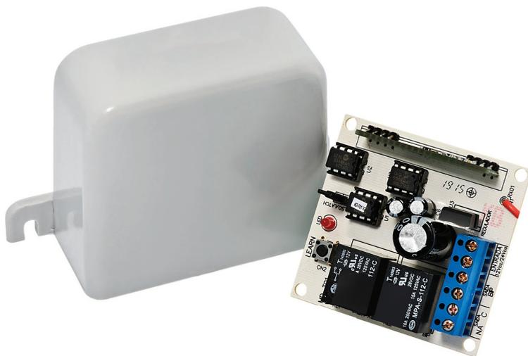
O MD-T01 é um módulo opcional de recepção externa com codificador Rolling Code integrado.
